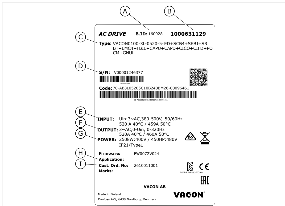
Rys. 2: Etykieta na opakowaniu przemienników częstotliwości VACON®
